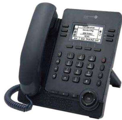
M3 桌面话机配备两个USB 接口 (TYPE A/C)，极大地扩展了M3 的功能，使其不仅仅是个单纯的话机还可以连接外部设备进行扩展，如扩展模块（EM20 或EM200）、耳机、会议模块等；M3 支持音频转接功能（Audio Hub），可连接PC作为外部扬声器，从而享受超宽带音频效果；M3 桌面话机通过USB 可连接Wi-Fi 外接模块，转变成为 Wi-Fi 桌面电话。
